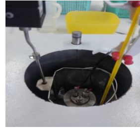
รูปที่ 4 การวิเคราะห์ค่าความร้อนโดยบอมบ์แคลอริมิเตอร์
