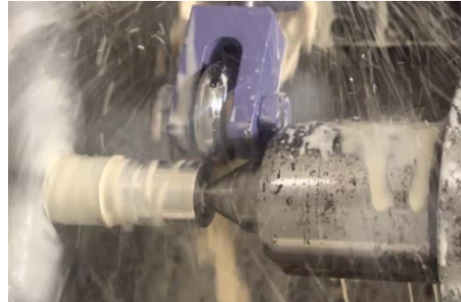
รูปที่ 6 กระบวนการติดตั้งชุดกดรีดปิดเงา และทดลอง
