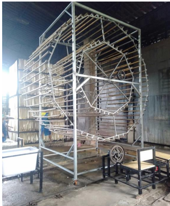
รูปที่ 3 ชุดอุปกรณ์ลำเลียงยางแผ่นที่สร้างขึ้น
