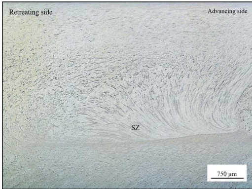
รูปที่ 9 โครงสร้างจุลภาคของของรอยเชื่อมที่ 790 รอบต่อหน้า
