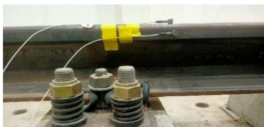
รูปที่ 8 การติดตั้งอุปกรณ์วัดความเร่งในทิศทางตามแนวตั้งและแนวด้านข้างในห้องปฏิบัติการ
