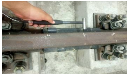
รูปที่ 10 การกระตุ้นให้เกิดการสั่นสะเทือนด้วยค้อนกระตุ้นตามแนวด้านข้าง
