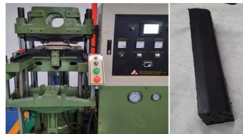
รูปที่ 5 เครื่องอัดแม่พิมพ์เพื่อขึ้นรูปตัวหน่วงรางชนิดยางธรรมชาติร่วมกับบิวไทล์
