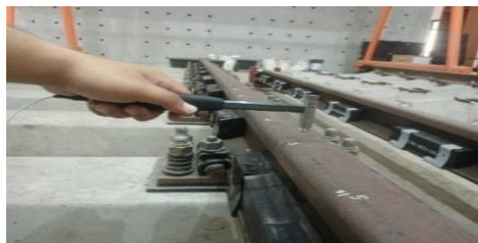
รูปที่ 9 การกระตุ้นให้เกิดการสั่นสะเทือนด้วยค้อนกระตุ้นตามแนวตั้งในห้องปฏิบัติการ
