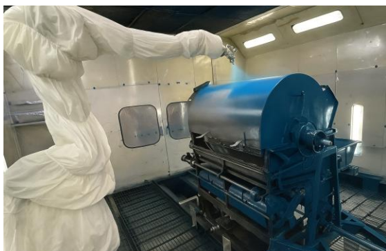
รูปที่ 2 กระบวนการพ่นสีเครื่องทอด้วย Robot
