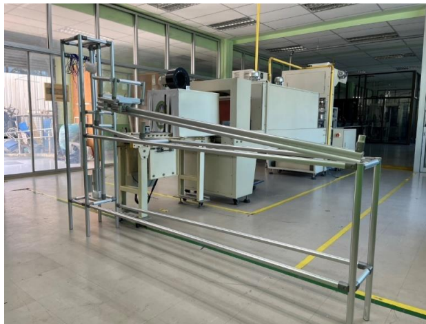
รูปที่ 6 ระบบเคลื่อนย้ายบรรจุภัณฑ์อัตโนมัติต้นทุนต่ำโดยใช้หลักการการควาคุรีโคเซ็น
