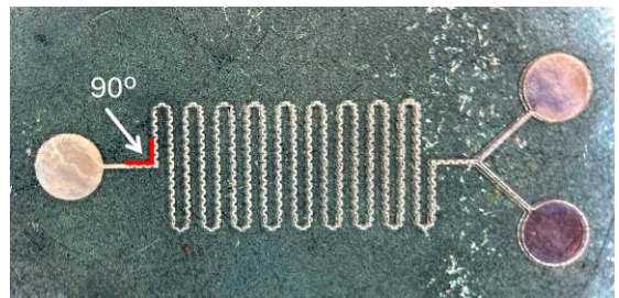
รูปที่ 7 แสดงความคมชัดโครงสร้างลดลายมุม 90 องศา
