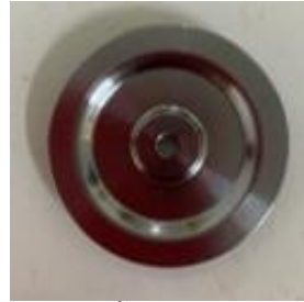
ก) ชิ้นงานลูกล้อก่อนเจาะรู
