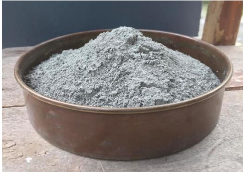
รูปที่ 3 ปูนซีเมนต์ไฮดรอลิกประเภทใช้ทั่วไปในงานโครงสร้าง (HLC)
