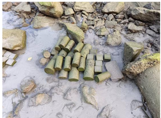
รูปที่ 8 คอนกรีตตัวอย่างที่บ่มในสภาวะเปียกสลบแห้ง
