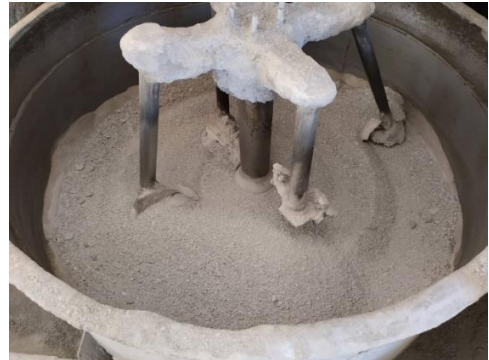
รูปที่ 11 การผสมคอนกรีตบล็อกด้วยเครื่องผสมคอนกรีต
