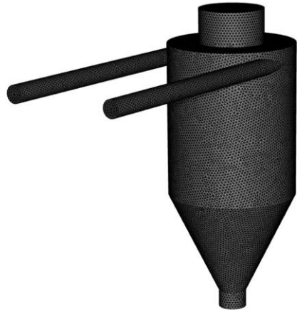
รูปที่ 2 รูปร่างห้องอบแห้งและกริดที่ใช้ในการจำลอง
