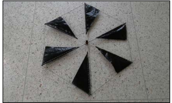
รูปที่ 5 โรเตอร์กังหันลมเพื่อลำแพนขนาด 1.0 เมตร
