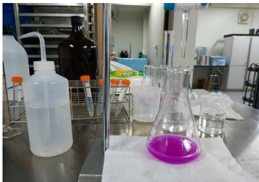
รูปที่ 3 การไทเทรตตัวอย่างน้ำมันกัญชาที่ผสมน้ำมันธรรมชาติด้วยสารละลายมาตรฐาน 0.1 N NaOH เพื่อการวิเคราะห์ปริมาณกรดไขมันอิสระ
