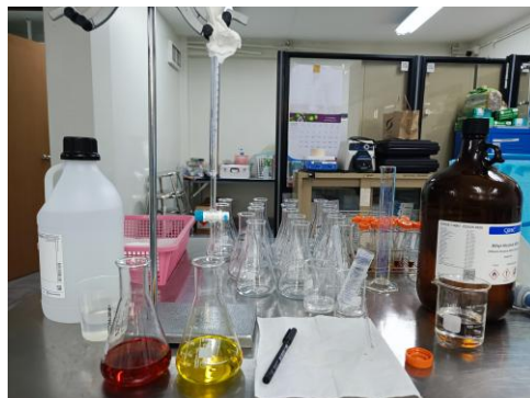
รูปที่ 4 การไทเทรตตัวอย่างน้ำมันกัญชาที่ผสมน้ำมันธรรมชาติด้วยสารละลาย 0.01 N \text{Na}_2\text{S}_2\text{O}_3 เพื่อการวิเคราะห์ปริมาณเปอร์ออกไซด์
