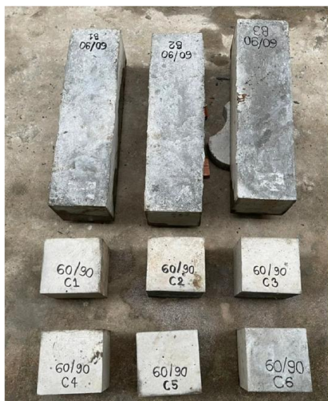
รูปที่ 1 ตัวอย่างทดสอบกำลังรับแรงอัดและกำลังรับแรงดัด
