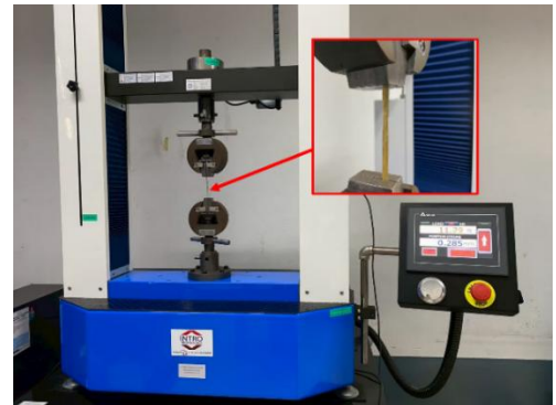
รูปที่ 4 เครื่องทดสอบแรงดึงอเนกประสงค์และลักษณะการจับยึดเส้นใยแก้วในชุดปากจับสำหรับการทดสอบความต้านทานแรงดึง
