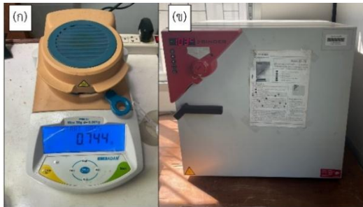
รูปที่ 3 อุปกรณ์ที่ใช้ในการวิเคราะห์ความชื้น (ก) เครื่องวิเคราะห์ความชื้นระบบอินฟราเรด ยี่ห้อ Adam Equipment และ (ข) ตู้อบแห้งแบบระบายอากาศ ยี่ห้อ Binder รุ่น ED-FD
