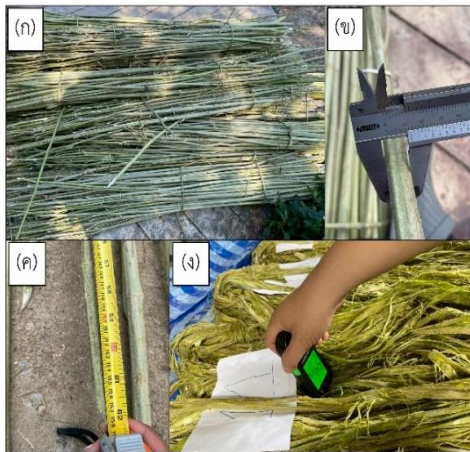
รูปที่ 1 ขั้นตอนการเตรียมชิ้นงานและการประเมินลักษณะทางกายภาพของต้นกล้วย (ก) ต้นกล้วยหลังการกำจัดใบและก้าน (ข) การวัดขนาดเส้นผ่านศูนย์กลางลำต้น (ค) การวัดความสูงของลำต้น และ (ง) การประเมินค่าความชื้นเบื้องต้นของเส้นใยกล้วยหลังการกะเทาะด้วยเครื่องวัดความชื้นชนิดพกพา
