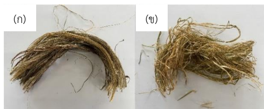
รูปที่ 8 ลักษณะทางกายภาพของเส้นใยกล้วยงหลังกระบวนการลดความชื้น (ก) การตากด้วยแสงแดดธรรมชาติเป็นเวลา 5-7 วัน และ (ข) การอบด้วยตู้อบลมร้อน
